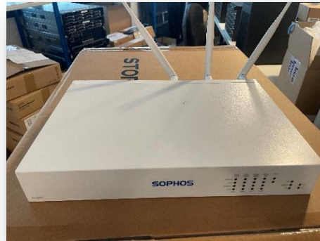
Figure 10 : routeur Sophos avec antennes Wifi
